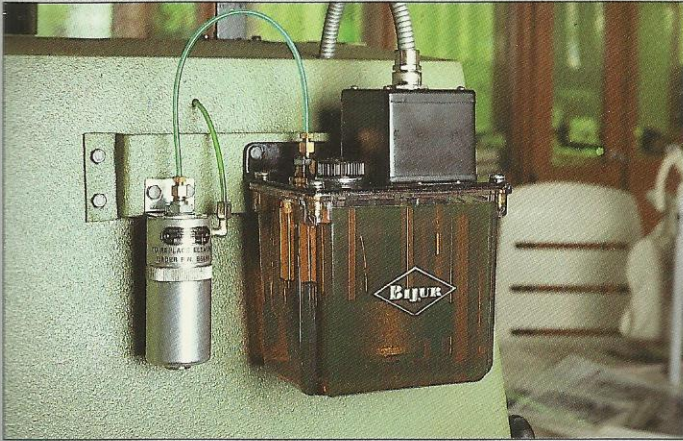
– Bomba de lubrificação automática do tapete – Automatic chain lubricating pump
