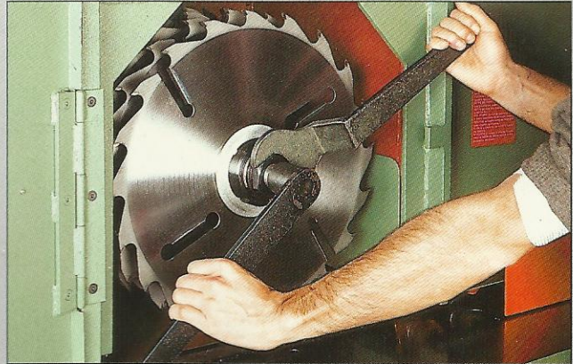
– Substituição do manchão com discos – Saw blades sleeve replacement
